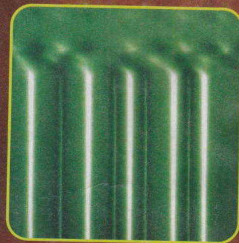
▲ Ingrandimento vertiginoso della superficie magnetizzata di una banda.
